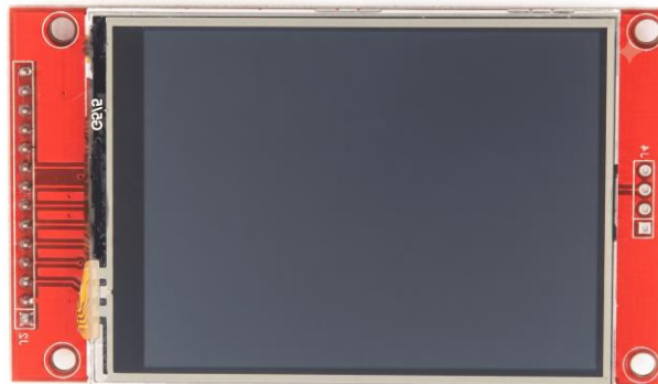
Gambar 2.6 TFT ILI9431 Sumber: Syam et al. (2024)
