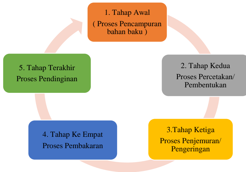
Gambar 2. 1 Proses Pembuatan Genteng
