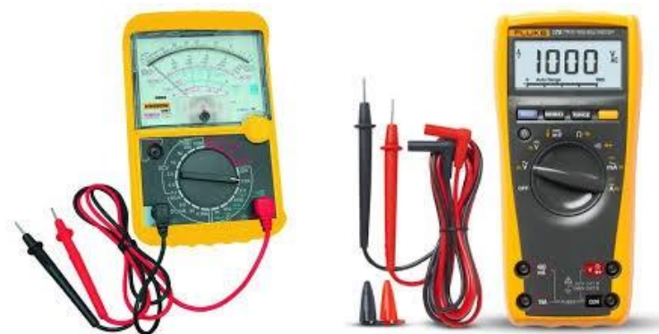
Gambar 2.1 Multimeter Analog (Kiri) dan Multimeter Digital (Kanan)
