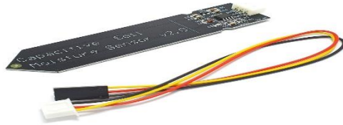
Gambar 2.3 Modul sensor soil moisture (Sumber : (Jupita et al., 2021))
